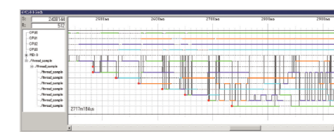
A. CPU単位の実行状況が表示されます B. プロセス、スレッド、タスクレベルでの実行遷移が表示されます
